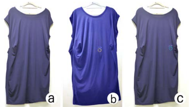
그림 7. 최종 프로토타입: 평소의 모습(a), 중앙 LED 가 켜진 모습(b), 오른쪽 LED 가 켜진 모습(c)
