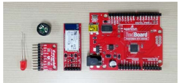
그림 3. 프로토타입 제작 부품. 스마트 가발의 프로토타입의 제작에는 MPU, MCU, 블루투스 모듈, 버저, LED 등의 부품이 사용되었다.
